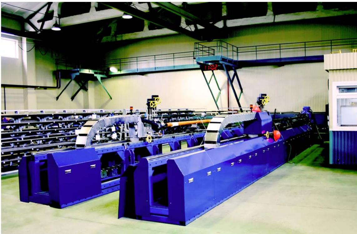
Рис. 6. Стенд для проведения прямо-сдаточных испытаний насосов
