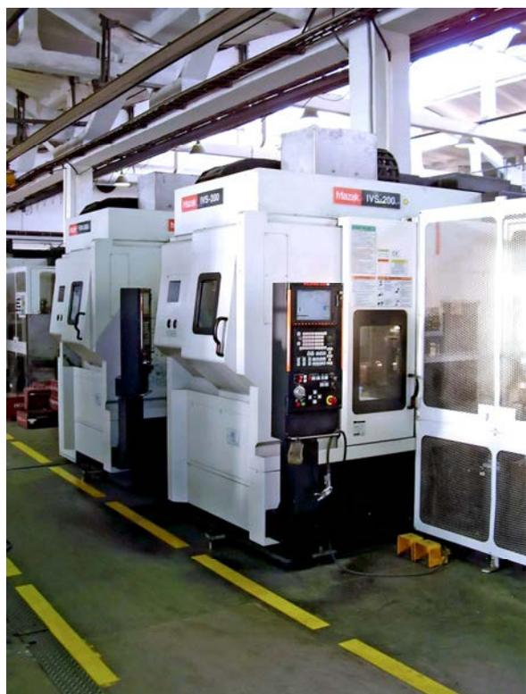
Рис. 14. Роботизированная линия IVS-200 фирмы «Мазак»
