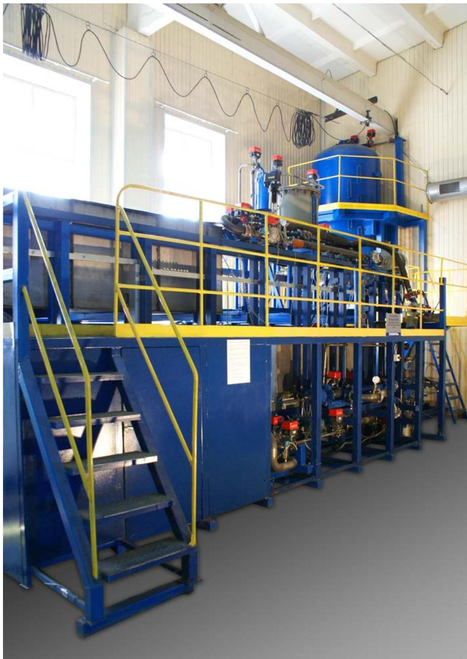
Рис. 4. Стенд для газожидкостных испытаний
