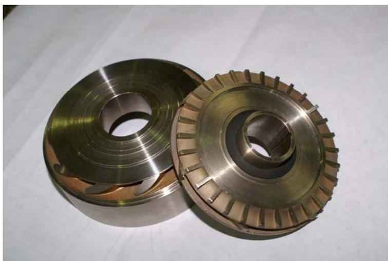
Рис. 3. Центробежно-вихревые ступени
