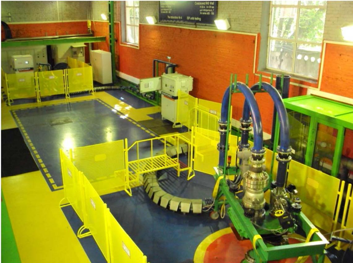
Рис. 5. Стенд-скважина для испытаний погружного оборудования
