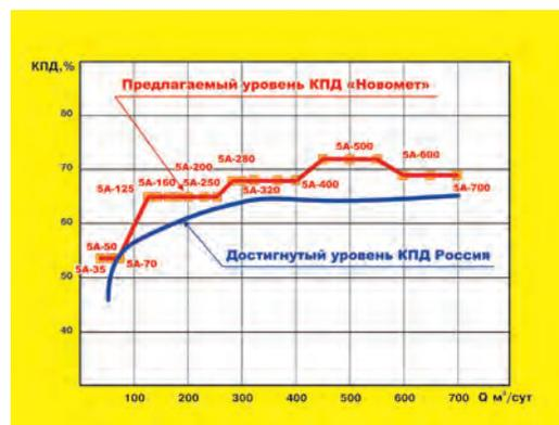
Рисунок 1. Сравнение ряда КПД насосов габарита 5А
