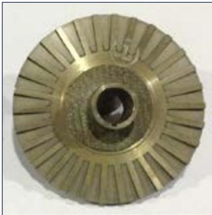
Рис. 4. Разгружающие лопасти открытого колеса [12]
