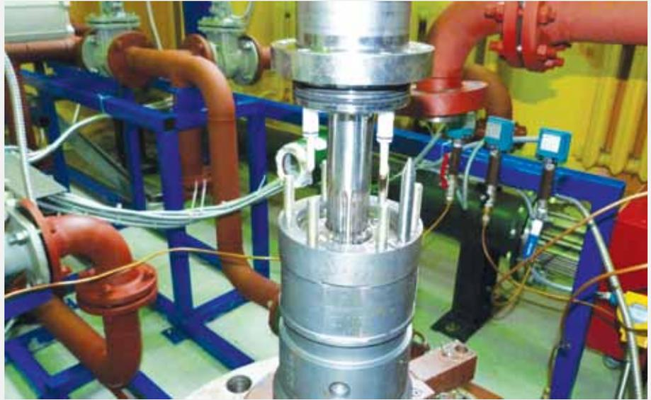
Рис. 4. Стыковка секций ПЭД
