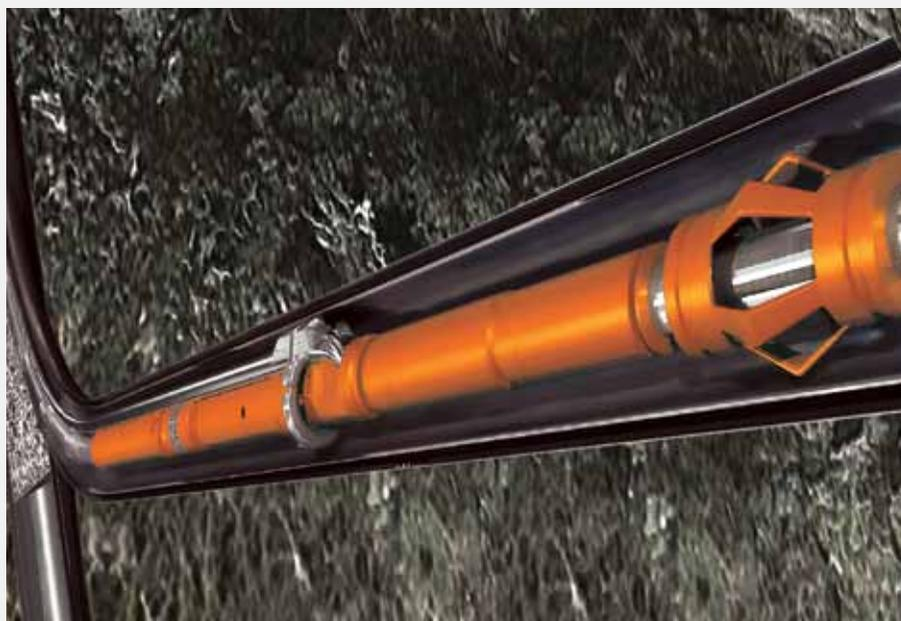
Рис. 1. Установка 2А габарита в боковом стволе
