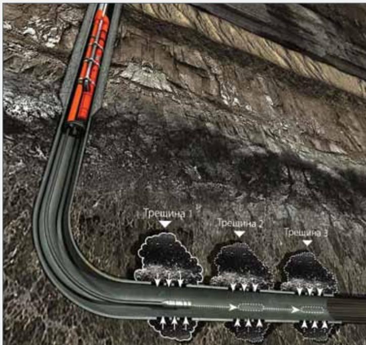
Рис. 1. Байпасная система с возможностью исследования горизонтального участка скважины с применением ГНКТ
