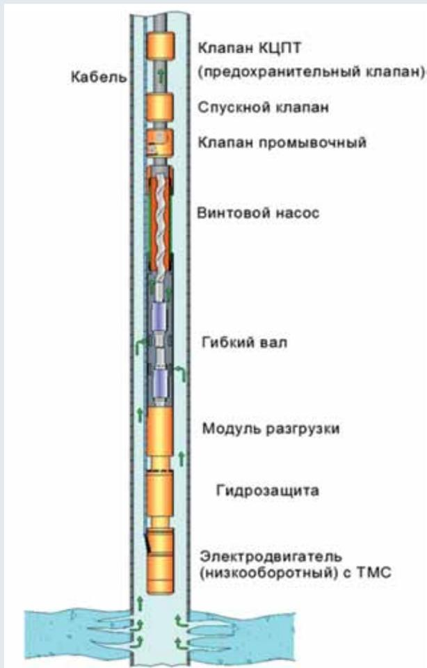
Рис. 1. Схема оборудования УЭВН
