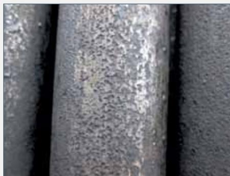
Рис. 3. Поверхность ГНКТ с дефектами (применяемая на месторождении ООО «Газпромнефть-Хантос»)
