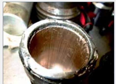
Рис. 4. Уплотнительная втулка (износ из-за пропанта в раковинах на поверхности ГНКТ)
