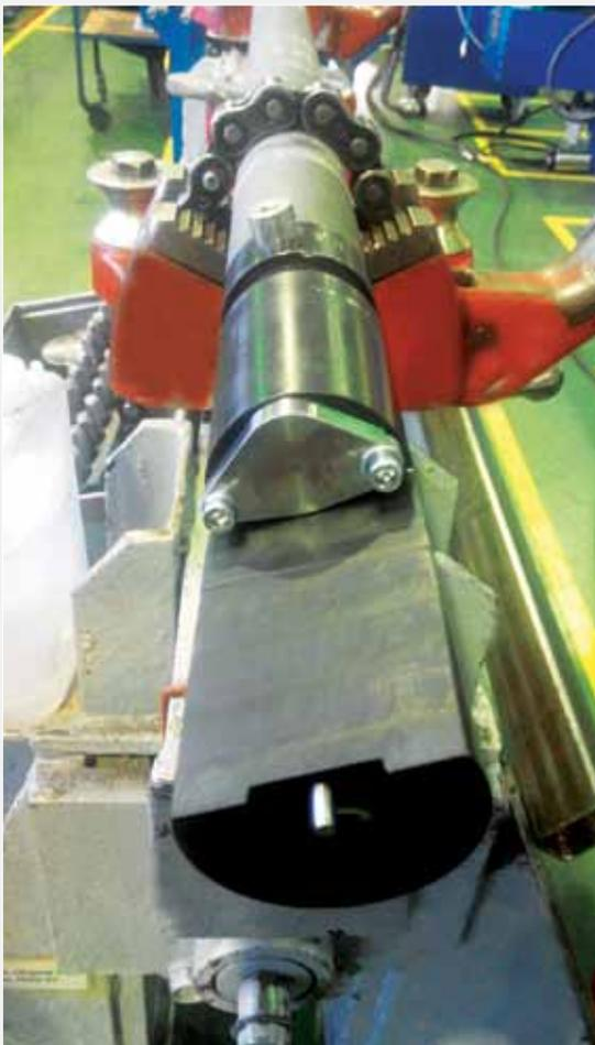
Рис. 3. Сборка вентильного двигателя 55 габарита
