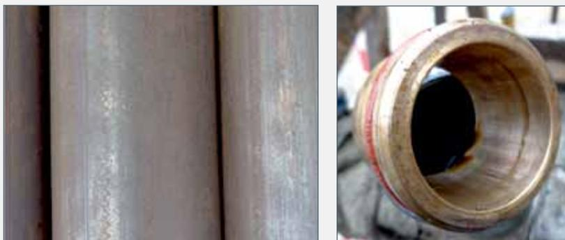
Рис. 6. Поверхность ГНКТ – гладкая без дефектов (применяется на месторождении ОАО «ВЧНГ») (слева). Втулка уплотнительная после исследований (справа)
