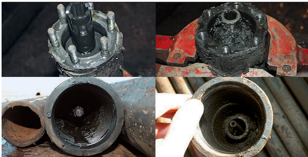
Рис. 4. Результаты разбора УВНН5-25-850/05-003 в новой комплектации
