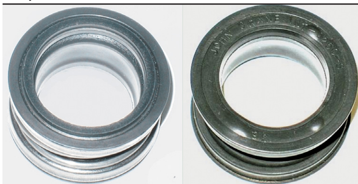
Рис. 6. Состояние торцевого уплотнения (рабочая и тыльная поверхности)
