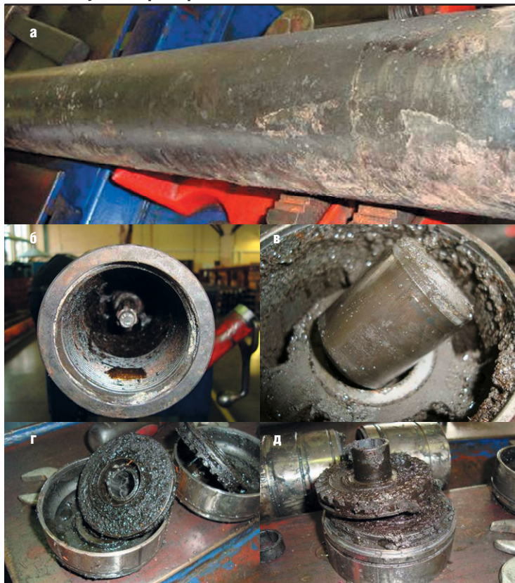
Рис. 4. Результаты разбора УВНН5-25-850/05-003 в новой комплектации
