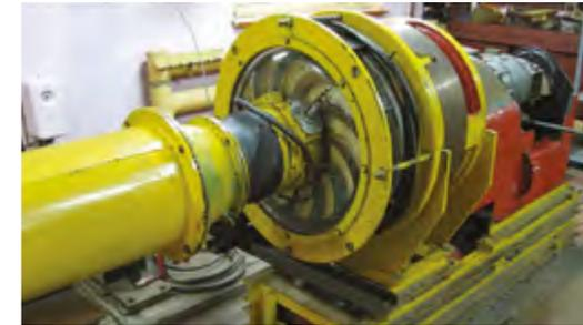
потока использовались цилиндрические трехканальные насадки, флажки и нити.
