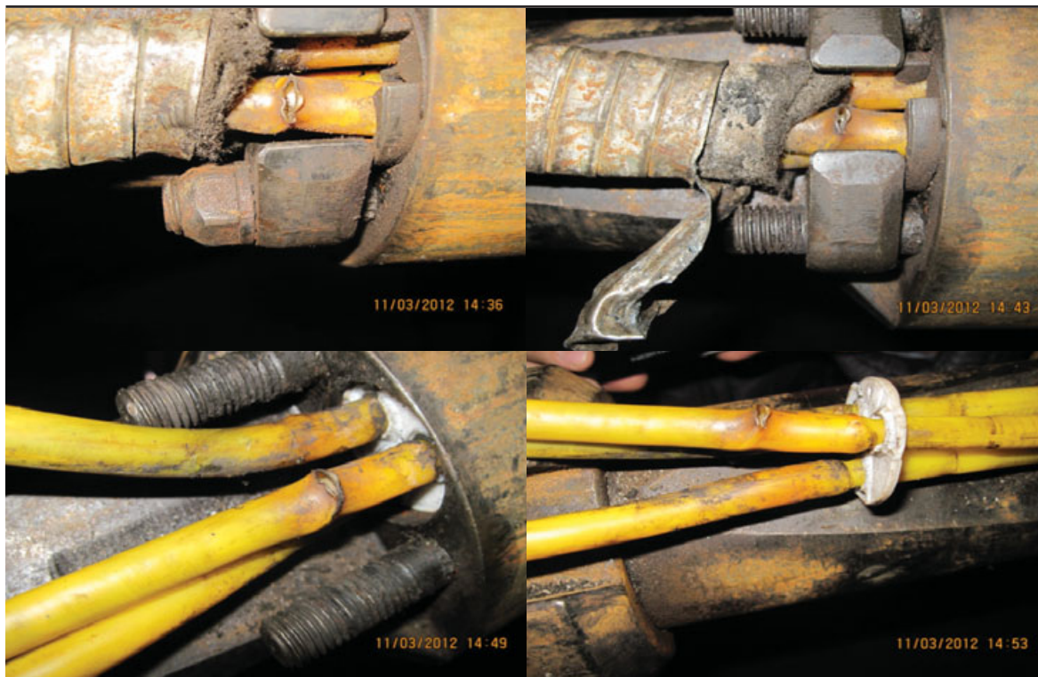
Рис. 5. Проблемы при внедрении: оплавление и прогар жил кабеля нижней части пакерной заделки
