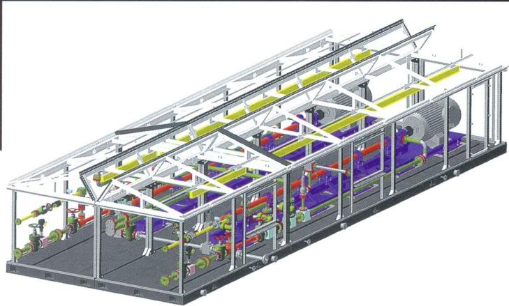
В соответствии с требованиями заказчика оборудование было изготовлено во взрывозащищенном исполнении (B1A) и оснащено энергоблоком (комплектной трансформаторной подстанцией) мощностью 250 кВт.
