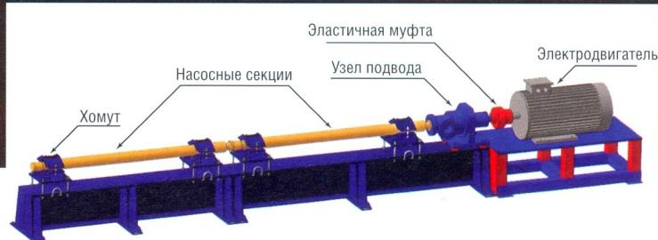
КОЙЛ-Коми). Конструкция станции – модульная, что позволяет транспортировать ее автомобильным или железнодорожным транспортом с соблюдением всех правил перевозки грузов. БНС устанавливается на специальный быстровозводимый фундамент из металлических профилей. Поскольку станции поставляются в максимальной готовности («под ключ»), сроки монтажных и пусконаладочных работ составляют, как правило, не более 14 суток.
