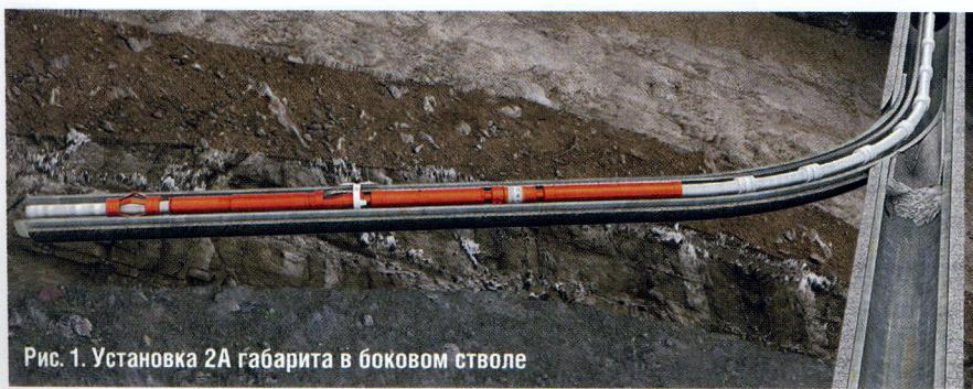
Рис. 1. Установка 2А габарита в боковом стволе
