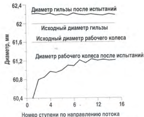
Рис. 5. Распределение износов рабочих колес и гильзы по длине осевого насоса 3 габарита, 15 ступеней (5700 об/мин, 4 час, 100 м³/сут)
