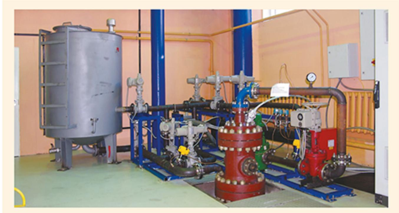
В общем случае схема установки при испытаниях представлена на рис. 1. Для испытаний была взята одна секция насоса номинальной производительностью 10 м<sup>3</sup>/сут с 53 ступенями, гидрозащита типа ГЗНМ, погружной низкооборотный вентильный электродвигатель 117 габарита с частотой вращения 500-1500 об/мин и номинальной мощностью 27 кВт. Также в процессе испытаний установка была снабжена погружным блоком телеметрии, погружными датчиками температуры и вибрации.
