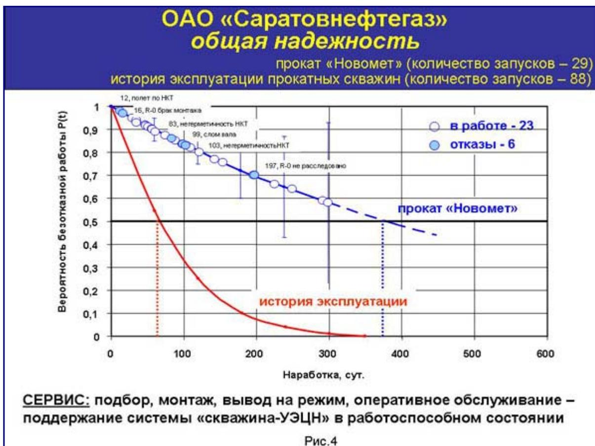
Похожий результат получен при сервисном обслуживании в «Саратовнефтегазе» (рис. 4) - наработку Т<sub>0,5</sub> за год работы удалось поднять с 78 до 380 суток.
